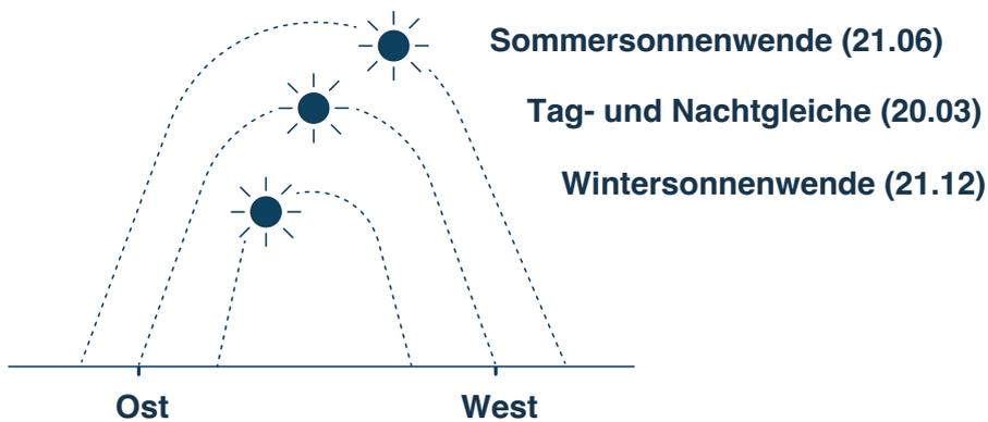
3. Abb.: Die Sonnenbahn im Sommer, Frühling und Winter unterscheidet sich im Anfangs- und Endswinkel, sowie maximal erreichtem Höhenwinkel.
